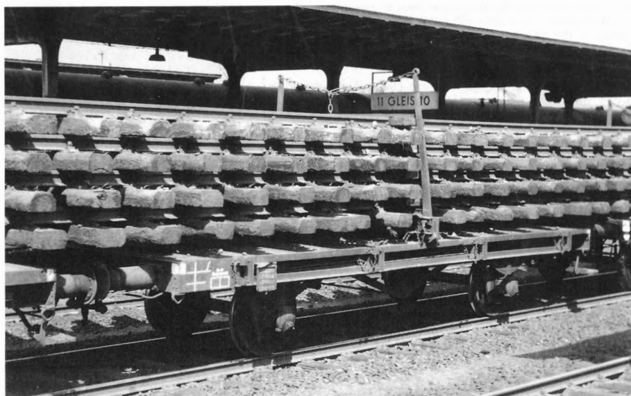
Bild 13. Auch zum Transportieren von Gleisjochen wurden die Drehschemelwagen eingesetzt; J. Claus fotografierte den H 10 mit der Nummer 992 112 am 25. 4. 1959 in Frankfurt am Main/Höchst.
