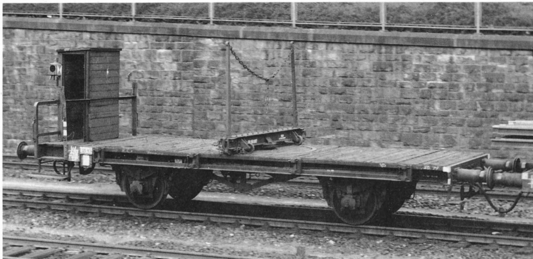
Bild 1. Ein H 10-Drehschemelwagen mit Handbremse und Bremsershaus, wie er der Bauzeichnung Bild 8 des heutigen Umbauvorschlags entspricht. J. Claus fotografierte am 22. 8. 1962 in Offenburg.
